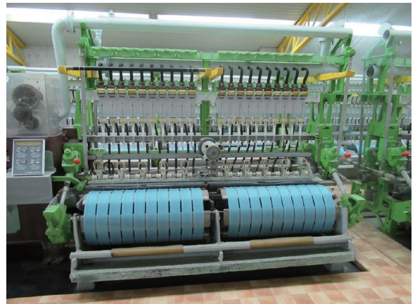
写真3 新型ハンク式紡糸機 1949年製、延岡工場展示 新型ハンク式紡糸機は東京農工大学科学博物館でも保管展示されている。
