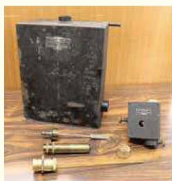
左:IM泉効計(昭和前期) 上:分解した部品一式 (いずれも理化学研究所 所蔵)
