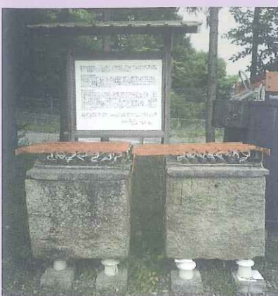
白御影石製電解槽 (昭和電工(株)東長原事業所蔵)
