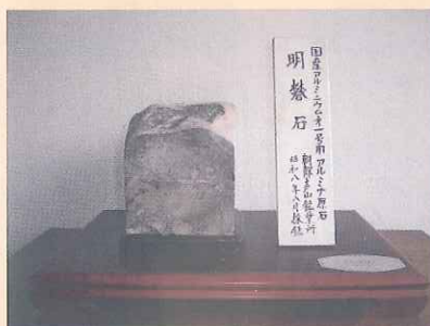
明礬石:国産初のアルミニウムの原料 (昭和電工(株) 横浜事業所 蔵)
