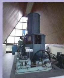
展示していたときの 酸素製造装置 (日本エア・リキード(株) 蔵)
