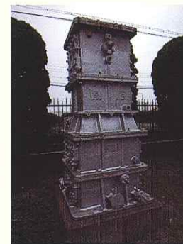
再製樟脳蒸留塔(部分) (日本テルペン化学株式会社 神戸工場所蔵)
