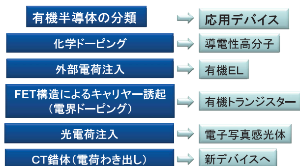
図2 有機半導体の分類と応用デバイス
