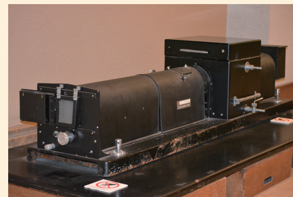
日立製作所製HTB-2A型チセリウス電気泳動装置 (北海道大学総合博物館 所蔵)
